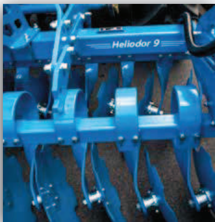
Disky v oblasti stopy traktoru samostatně nastavitelné
