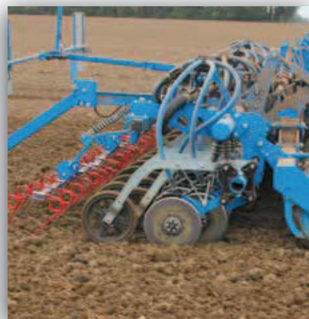
Dvoudisková secí botka OptiDisc hydraulicky přítlak na botku až do 70 kg
