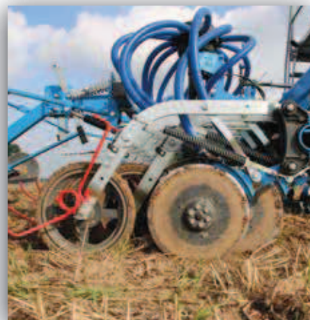
Dvoudisková secí botka OptiDisc mechanický přítlak na botku až do 45 kg
