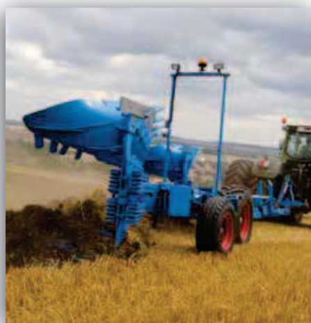
Zadní část pluhu s dobrým kopírováním půdy
