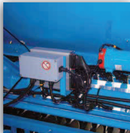
Elektrický výsevní hřídel s precizním dávkováním
